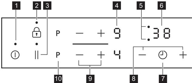
Gebruik de tiptoetsen om het apparaat te bedienen. De displays, indicatielampjes en geluiden tonen welke functies worden gebruikt.
